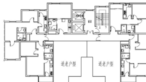
标准户型平面组合示例十三：无障碍适老户型位置示意（户型 C1-1 改造）
