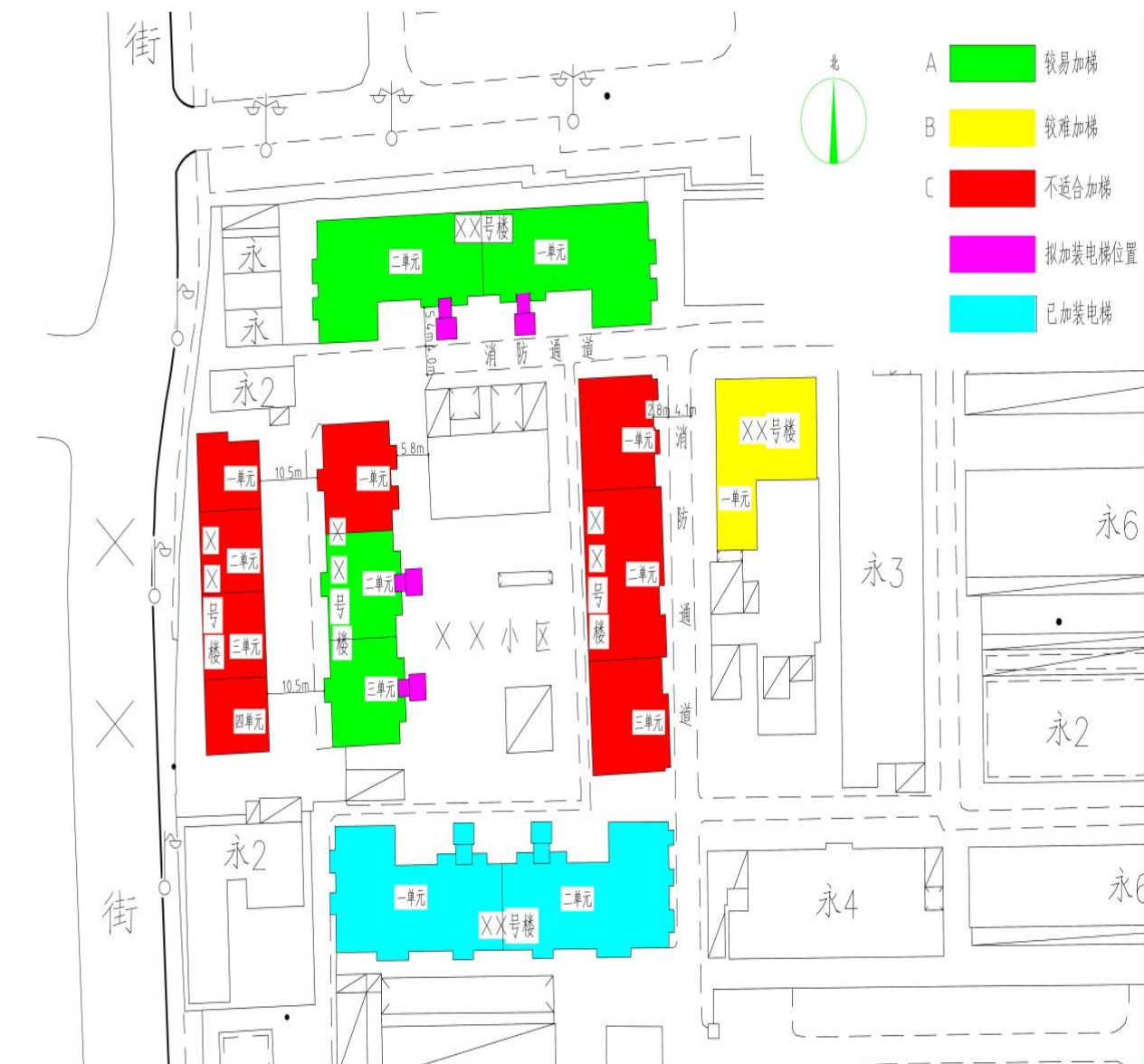
图 7-1 ××小区加装电梯可行性评估初步结论总平面示意图
