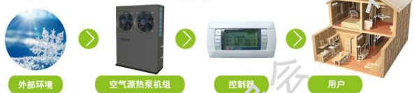
图6 空气源热泵采暖系统技术模式
