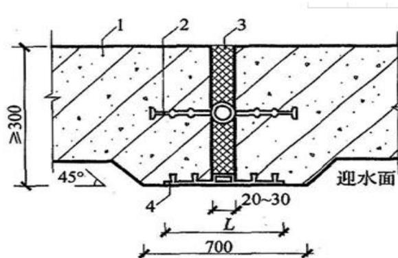
图 20.1.1-1 中埋式止水带与外贴防水复合使用
