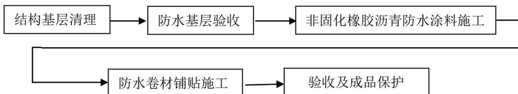
图 18.4.1 非固化橡胶沥青防水涂料与卷材复合防水施工工艺流程图
