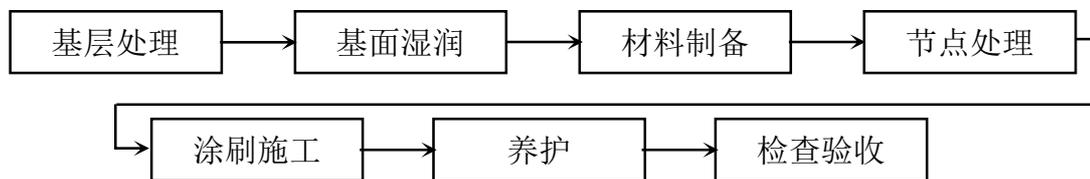
图 15.4.2 水泥基渗透结晶型防水材料涂刷施工工艺流程
