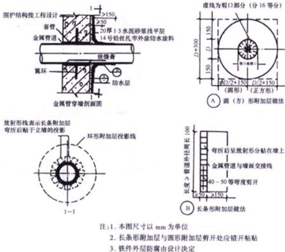
图 5.4.5-3 穿墙管附加层剪裁（图中实线为裁剪线，虚线为折叠线）
