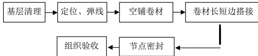
图 10.4.1 预铺沥青基聚酯胎防水卷材施工流程
