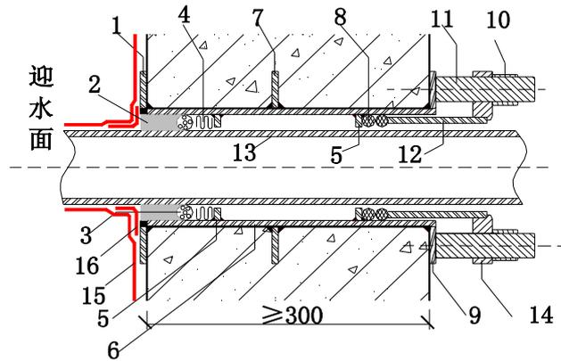
图 20.3.1-3 套管式穿墙管防水构造
