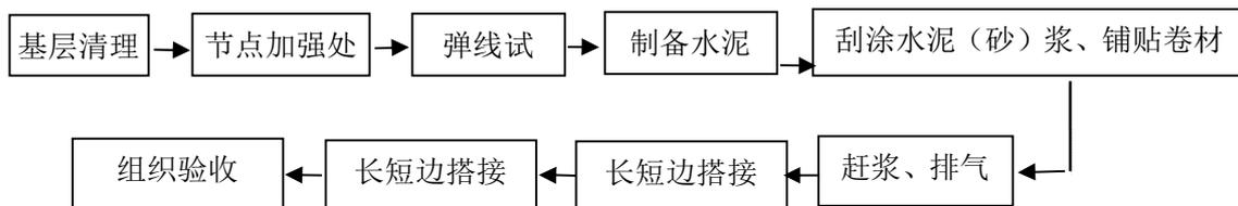
图 11.4.1 湿铺沥青基防水卷材施工流程
