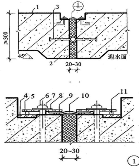
20.1.1-3 中埋式止水带与可卸式止水带复合使用
