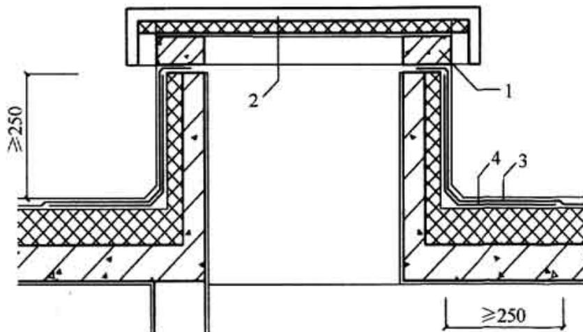
图 21.8.1 垂直出入口防水构造
