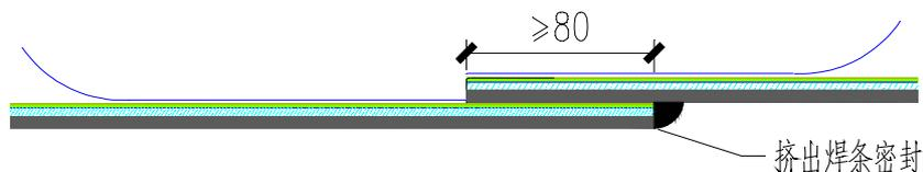
图 6.4.14 自粘高分子卷材搭接粘结节点构造示意图
