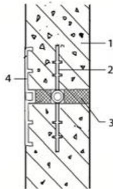
图 20.1.1-4 地下室侧墙变形缝防水构造
