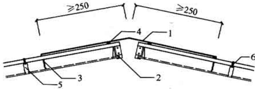
图 21.11.3 金属板材屋面屋脊防水构造
