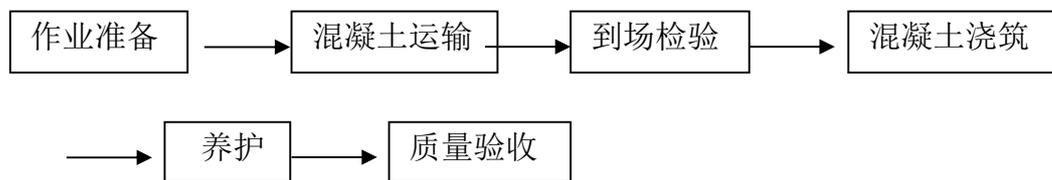
图 3.4.1 防水混凝土施工工艺流程
