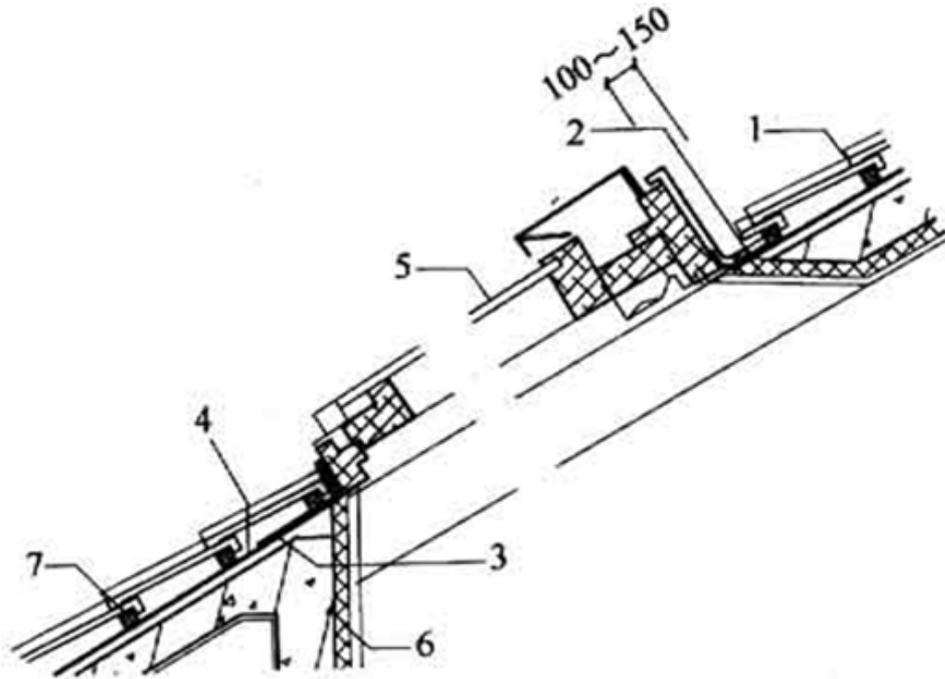
图 21.12.1 烧结瓦、混凝土瓦屋面屋顶窗防水构造
