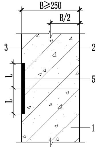
图 3.4.4(2)施工缝外贴止水带防水构造
