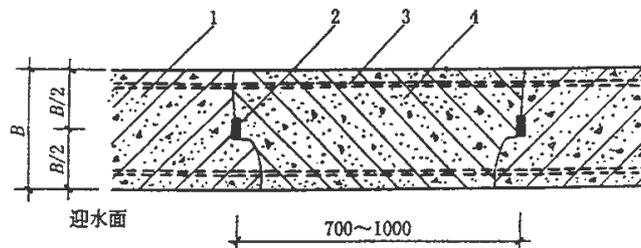
图 20.2.1-3 后浇带防水构造(三)
