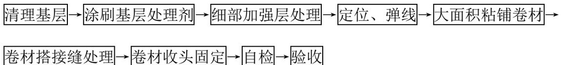
图 5.4.1 自粘聚合物改性沥青防水卷材施工工艺流程
