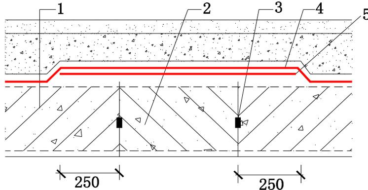
图 20.2.1-5 地下室顶板后浇带防水构造
