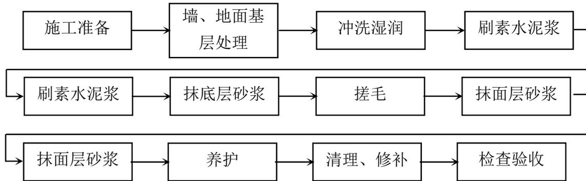
图17.4.1 聚合物水泥防水砂浆施工工艺流程图
