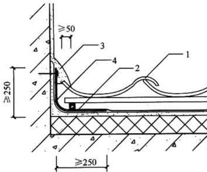
图 21.4.3 烧结瓦、混凝土瓦面山墙
