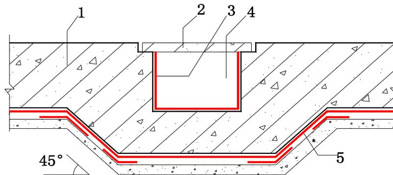
图 20.7.2 底板下坑、池的防水构造
