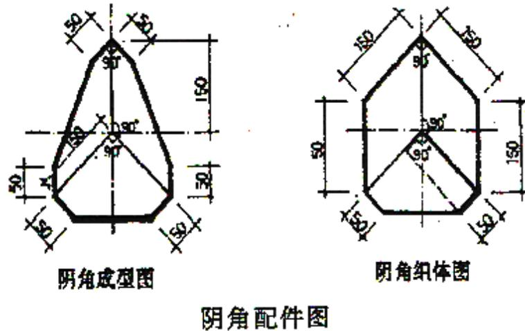
图 5.4.5-2 阴角附加层剪裁（图中实线为裁剪线，虚线为折叠线）
