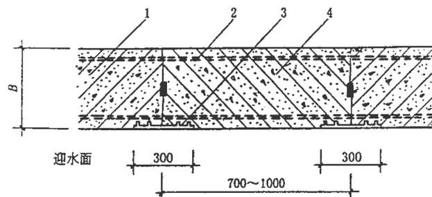
图 20.2.1-2 后浇带防水构造(二)
