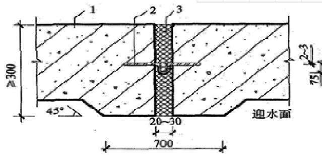
图 20.1.1-5 中埋式金属止水带
