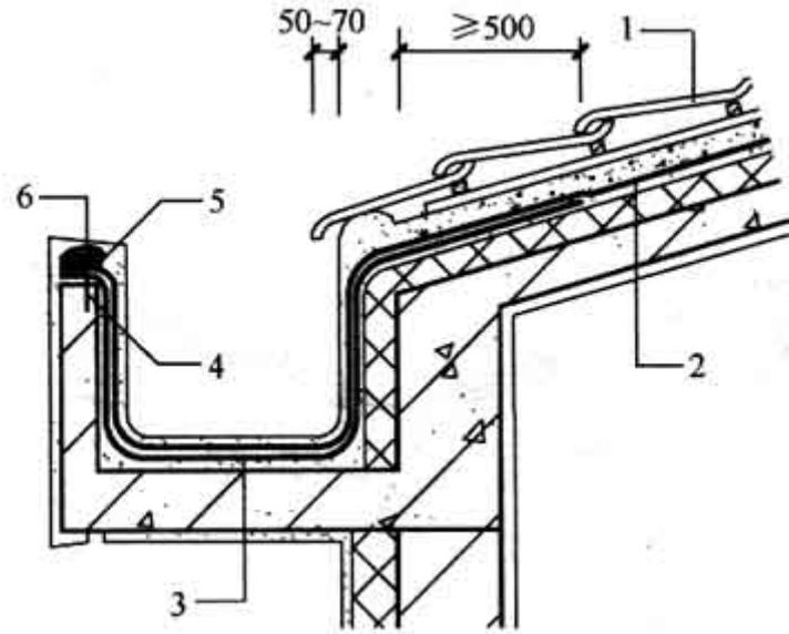
图 21.2.2 烧结瓦、混凝土瓦屋面檐沟
