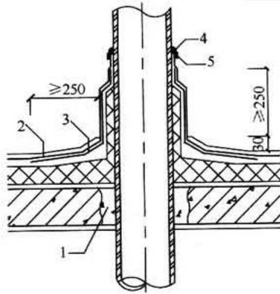
图 21.7.3 出屋面管道防水构造
