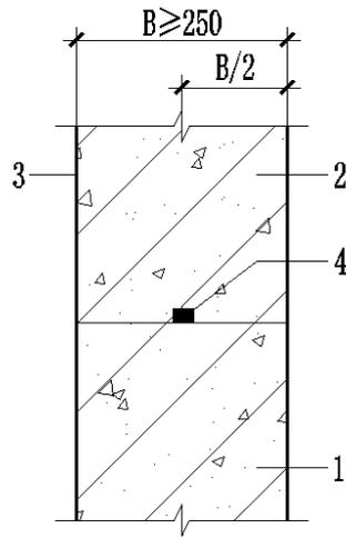
图 3.4.5-3 施工缝遇水膨胀止水条防水构造
