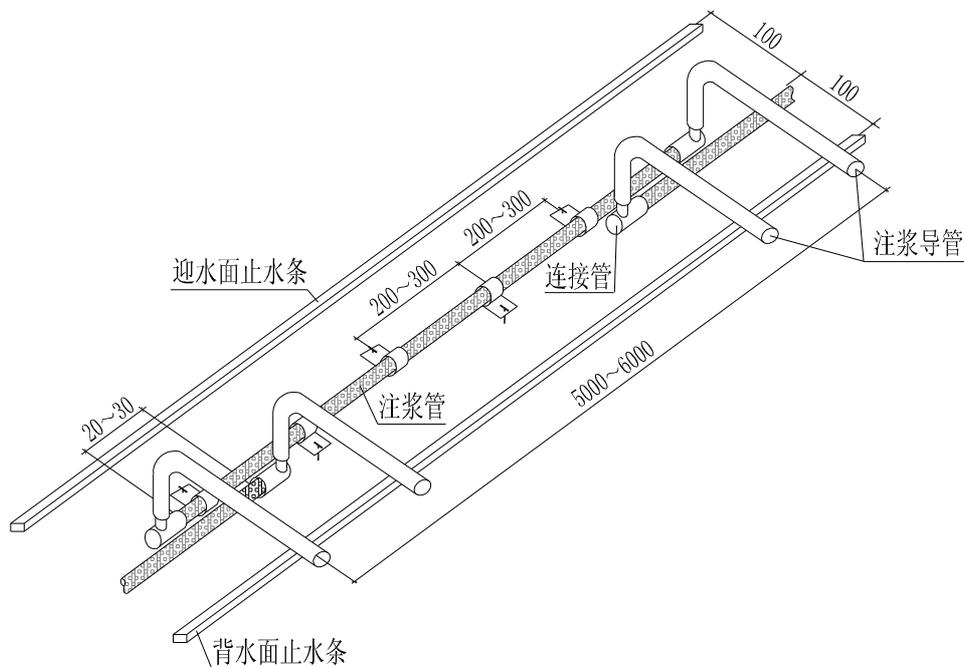
图 19.4.3 混凝土接缝注浆管的安装
