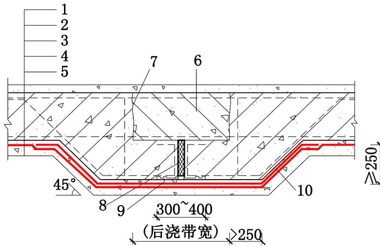
图 20.2.1-4 地下室底板后浇带超前止水构造
