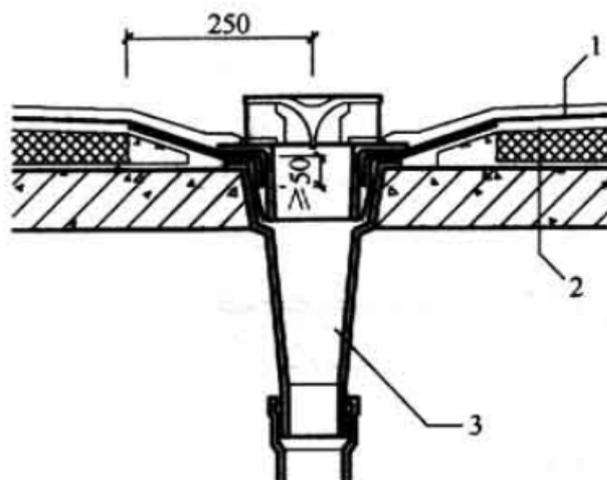
图 21.5.4 -2 直式水落口材防水构造
