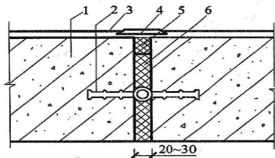
图 20.1.1-2 中埋式止水带与嵌缝材料复合使用
