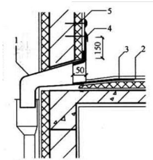
图 21.5.4-1 横式水落口材防水构造
