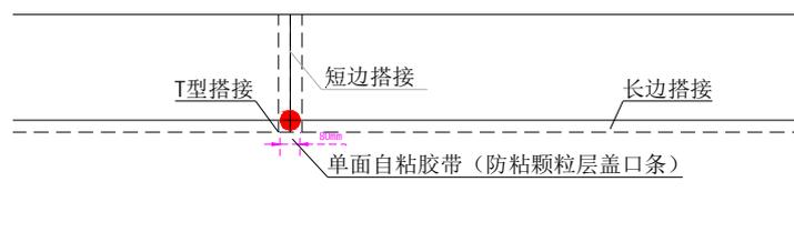
图 6.4.7 T型接头部位节点构造示意图
