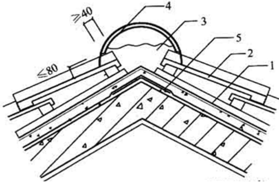
图 21.11.1 烧结瓦、混凝土瓦屋脊防水构造
