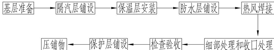
图 8.4.14 空铺压顶法施工工艺流程
