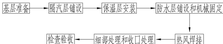
图 8.4.8 机械固定法施工工艺流程
