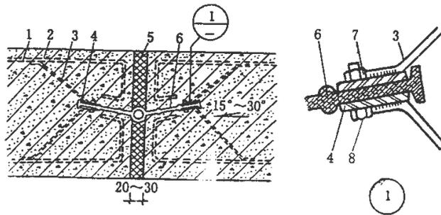
图 20.1.2-1 顶(底)板中埋式止水带的固定
