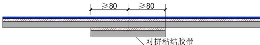
图 6.4.6 短边粘结节点构造示意图
