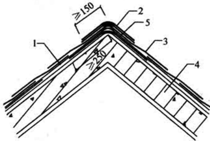
图 21.11.2 沥青瓦屋面屋脊防水构造
