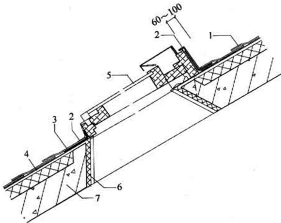
图 21.12.2 沥青瓦屋面屋顶窗防水构造
