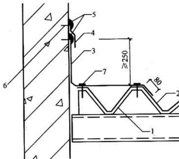
图 21.4.5 压型金属板屋面山墙防水构造
