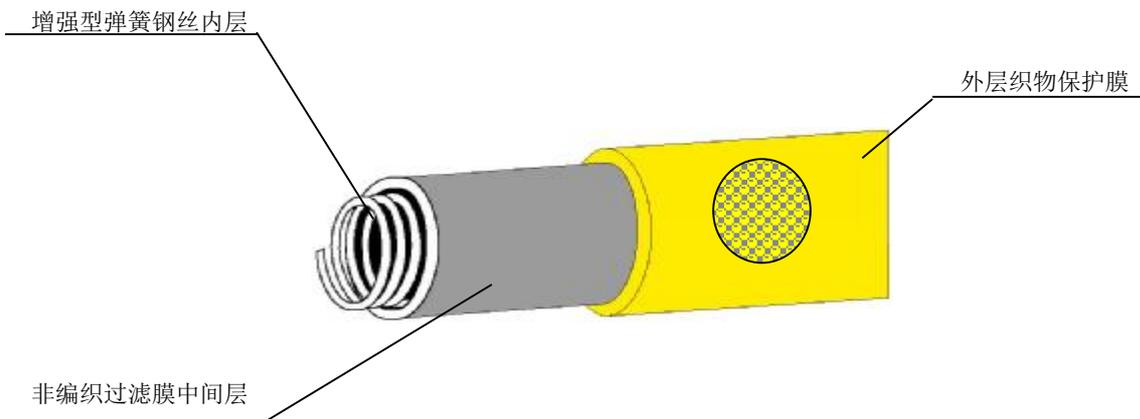
图 1 钢丝骨架注浆管构造示意图
