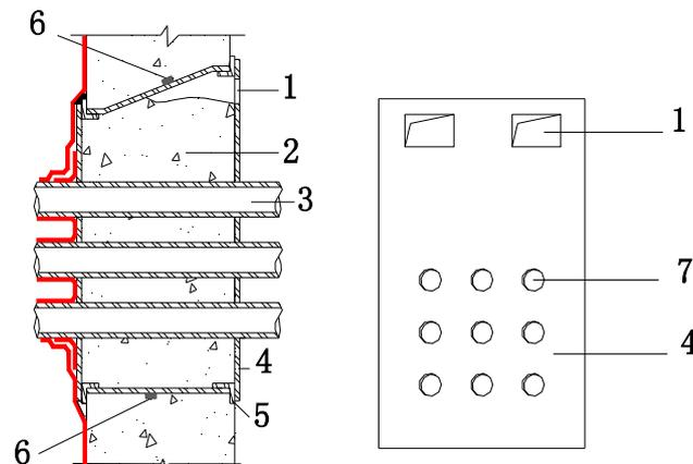
图 20.3.1-4 穿墙群管防水构造
