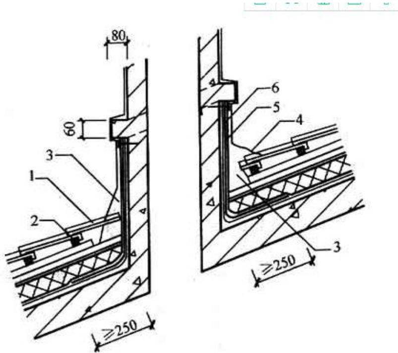
图 21.7.5 烧结瓦、混凝土瓦烟囱防水构造
