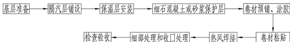
图 8.4.14 满粘法施工工艺流程
