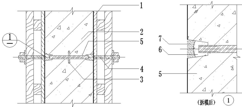
图 3.3.3 固定模板用螺栓的防水做法
