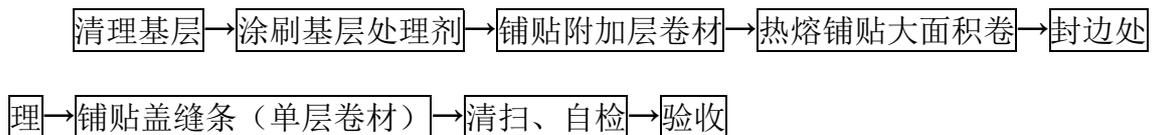
图 4.4.1 弹性体改性沥青防水卷材施工工艺规程
