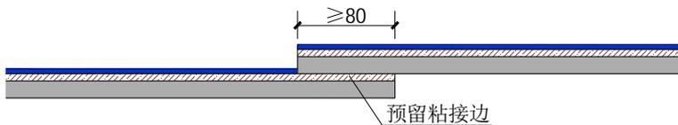
图 6.4.5 长边粘结节点构造示意图
