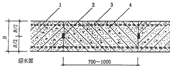
图 20.2.1-1 后浇带防水构造(一)
