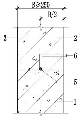
图 3.4.5-4 施工缝预埋注浆管防水构造
