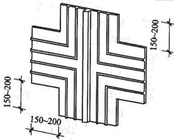
图 20.1.2-2 外贴式止水带在施工缝与变形缝相交处的十字配件
