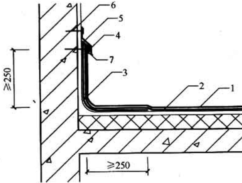
图 21.4.4 沥青瓦面山墙防水构造
