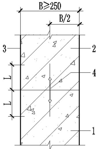
图 3.4.5-1 施工缝止水钢板防水构造
