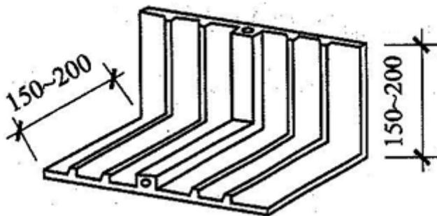
图 20.1.2-3 外贴式止水带在转角处的直角配件
