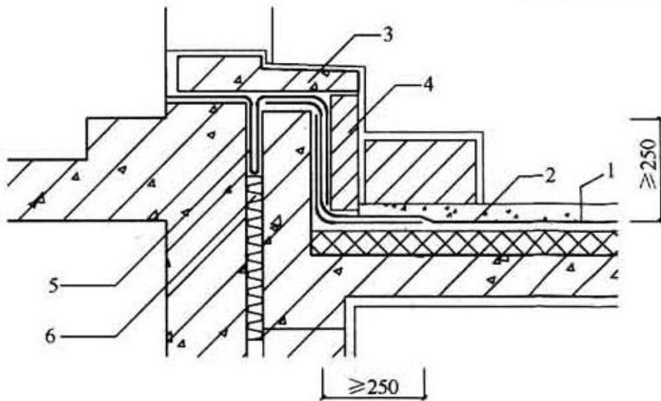
图 21.8.2 水平出入口防水构造
